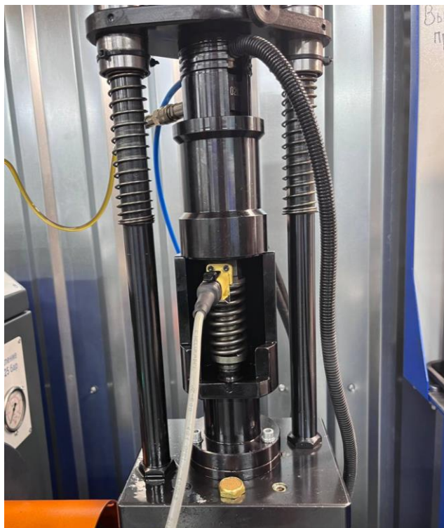
Рисунок 2.8 – Установка форсунки на Камбок
